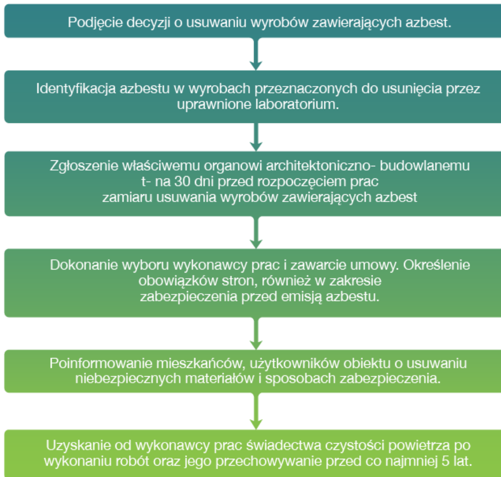
Rysunek 3. Procedura 2. Obowiązki i postępowanie właścicieli i zarządców, przy usuwaniu wyrobów zawierających azbest z obiektów lub terenów
